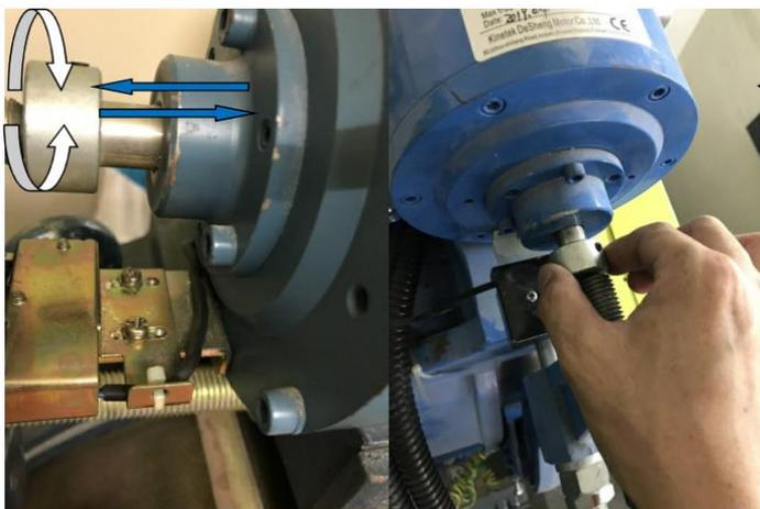
1、用手握住磁力器动芯左右旋转、前后推拉，确认其是否转动灵活？如果有过紧或卡阻现象，内部可能已存在磨损。
