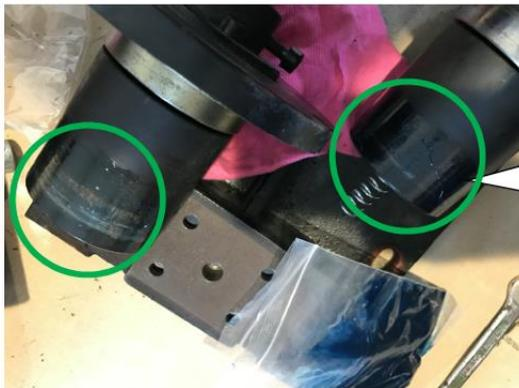
3、在动芯工作面的表面涂抹耐高温达润滑脂。装回动芯及端盖，扭紧两侧端盖上的固定螺钉，用手左右旋转、前后推拉动芯，要求动芯运动顺畅无卡阻。
